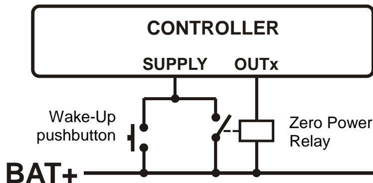
El controlador se inicia a través del botón de inicio. Se va a activar inmediatamente la salida de cero potencia y el relé asociado va a alimentar al controlador.
