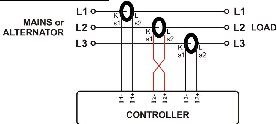
El generador está cargado todavía con 100 kW en cada fase. El factor de potencia de la carga(PF) es 1. PF en la fase L2 va a mostrar -1,00 debido a la polaridad invertida del TI. El resultado es que la potencia total del generador mostrada en el control es 100 kw. Los valores medidos son como sigue:
