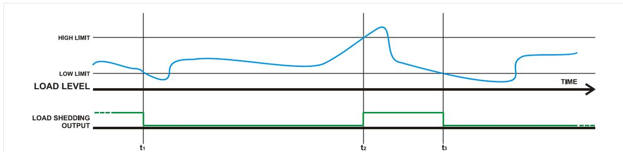
**t1:** La carga es inferior a Load Shedding Low Limit, entonces la salida queda desactivada.
