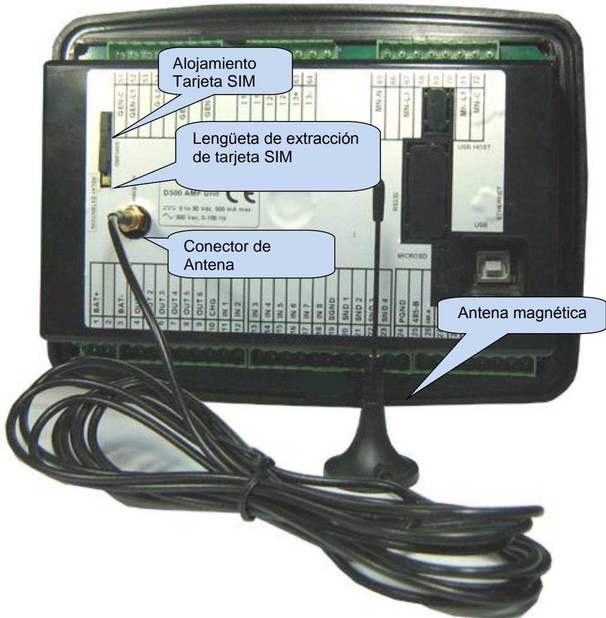
El modulo requiere una tarjeta SIM habilitada para GPRS para una funcionalidad full. Las tarjetas SIM del tipo de voz solamente usualmente no funcionarán correctamente.
