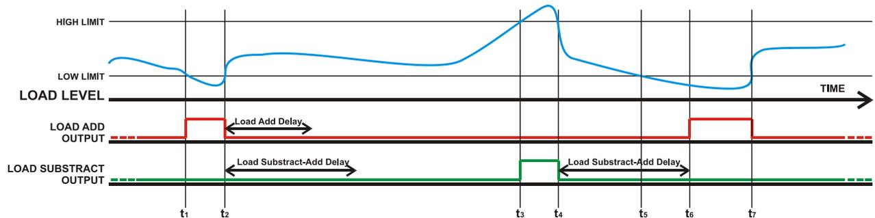
**t1:** la carga cae debajo del límite inferior de Load Shedding, la salida de agregado de carga se activa.
