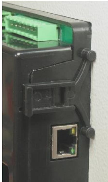
Instalación de la traba tipo autoajustable.
