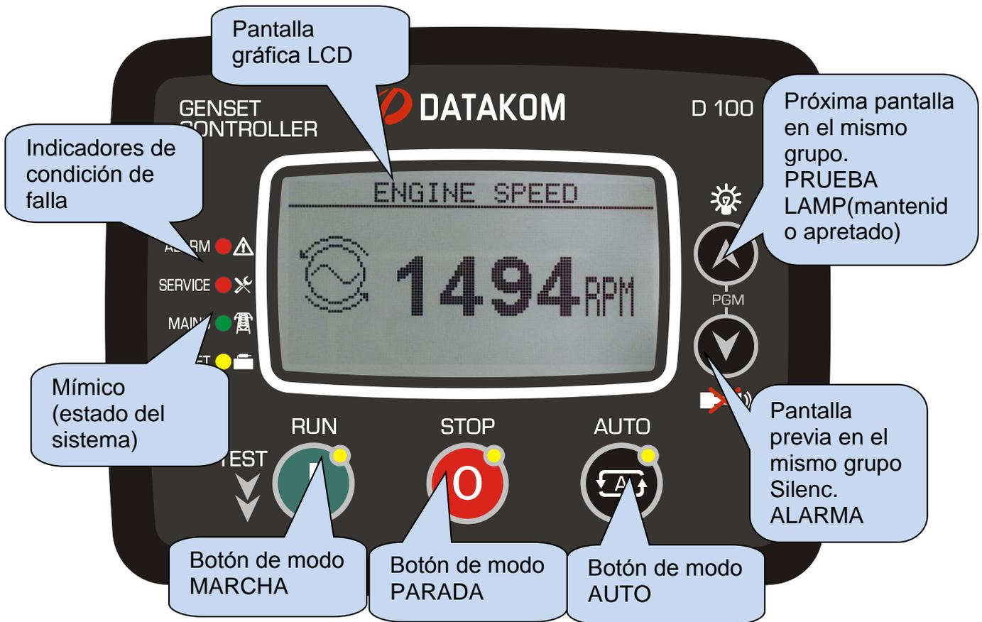
Cuando se cumplen las horas del motor **O** el tiempo para el servicio, el led (rojo) de **REQUERIMIENTO DE SERVICIO** va a empezar a parpadear y la función de la salida de servicio requerido se va a activar. El servicio requerido puede también crear una condición de falla de cualquier nivel según cómo se haya parametrizado.
