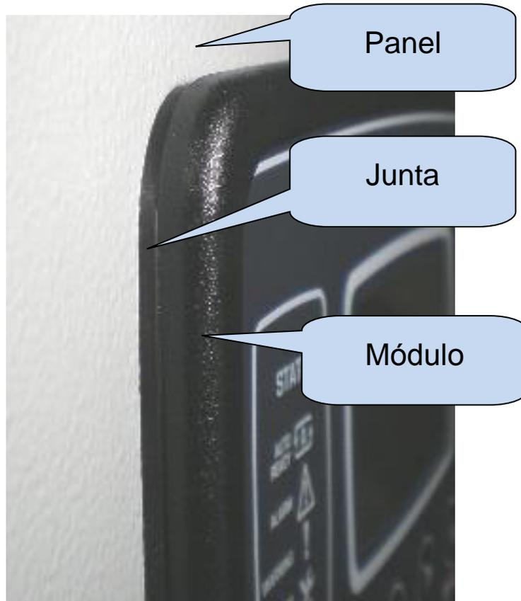
La junta de goma provee una protección contra el agua cuando se monta en el panel del tablero del G. E. Junto con la junta una protección IEC 60529-IP65 puede alcanzarse desde el panel frontal. Una corta definición de protección IP se da a continuación:
