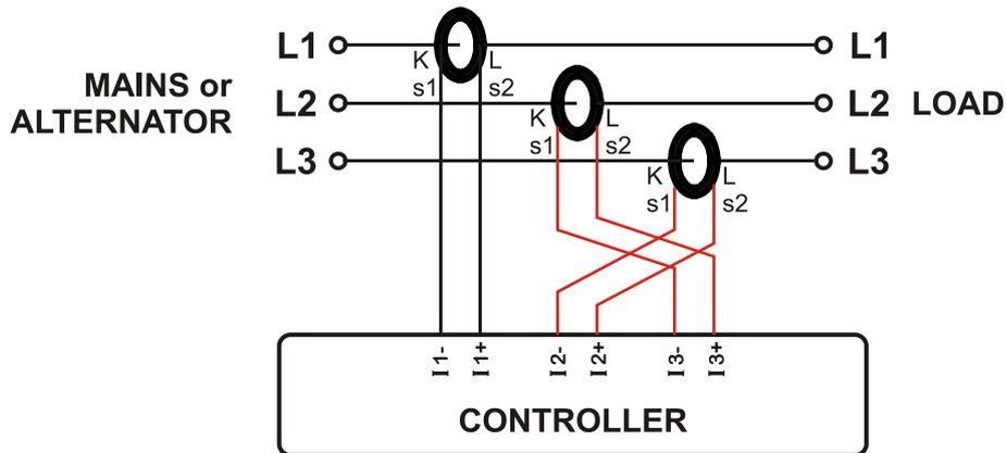
El generador está cargado todavía con 100 kW en cada fase. El factor de potencia de la carga(PF) es 1. PF en las fases L2 y L3 va a mostrar -0,50 debido al cambio de fase entre tensiones y corrientes causado por el intercambio de los TI. El resultado es que la potencia total del generador mostrada en el control es 0 kw. Los valores medidos son como sigue:
