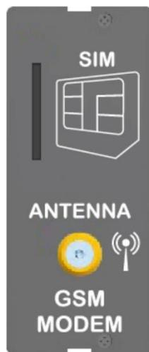
Место подключения модуля в контроллеры серии D-XXX МК2:
